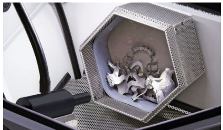
Zeit- und Kostenersparnis: Der große rotierende Stahlkorb ermöglicht gleichzeitiges Abstrahlen von bis zu 7 Objekten
