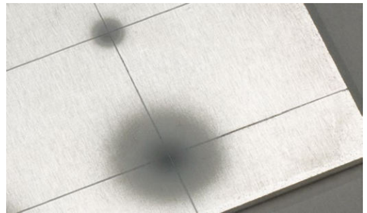
Punktgenaues und sparsames Strahlen. Oben: Renfert Strahlfokus. Unten: Strahlfokus eines Wettbewerbers
