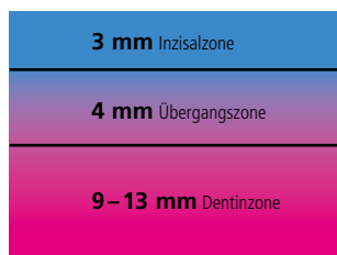
Dentin-/Inzisaufteilung von der ungesinterten IPS e.max ZirCAD Prime-Disc
